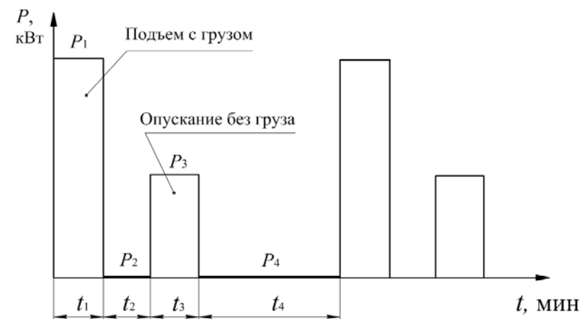
Рис. 20.1. Нагрузочная диаграмма подъемной лебедки
